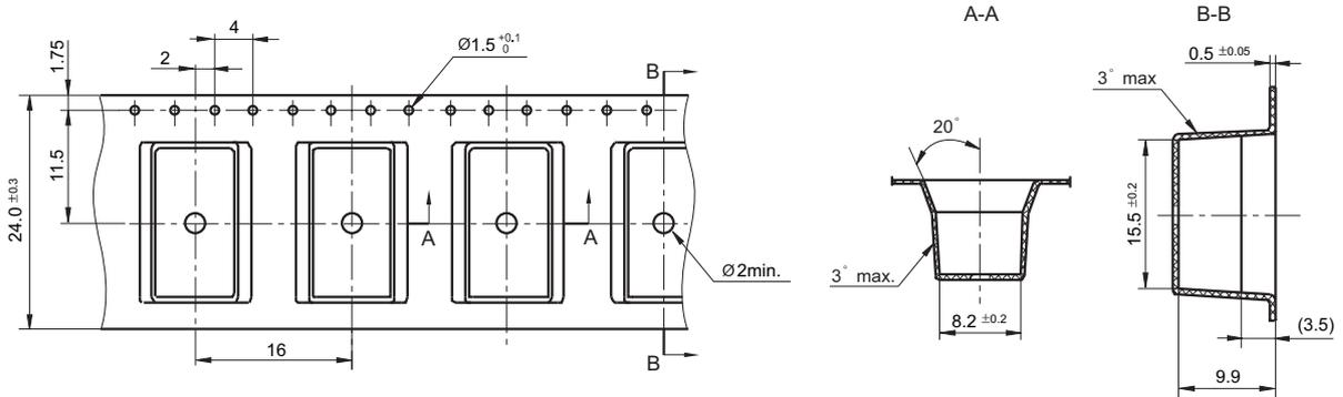
备注: (1) 产品部分外形尺寸未注尺寸公差, 当外形尺寸 $\leq 1\text{mm}$ , 公差为 $\pm 0.2\text{mm}$ ; 当外形尺寸在 $(1 \sim 5)\text{mm}$ 之间时, 公差为 $\pm 0.3\text{mm}$ ; 当外形尺寸 $> 5\text{mm}$ , 公差为 $\pm 0.4\text{mm}$ ;
